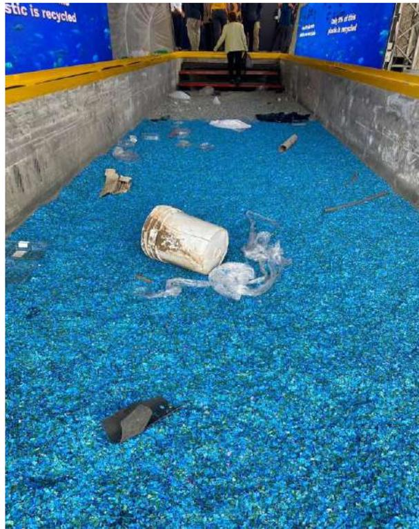
*Nota:* Material resultante del reciclaje de productos de plásticos no valorizables que pueden ser usados como parte de mezclas para elementos constructivos. Fotografía propia, 2022.
