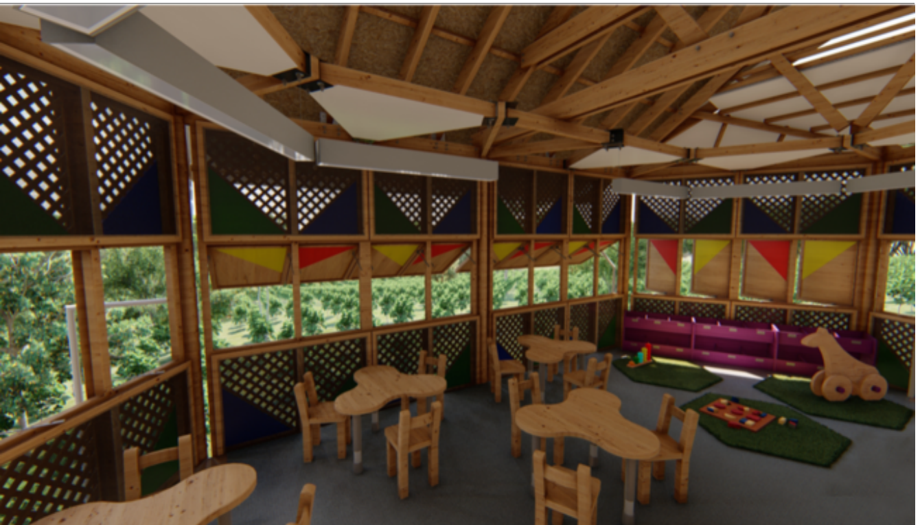
Interior del módulo A para maternal, con mobiliario pertinente y alturas manejadas para usuarios en tres distintas áreas internas, iluminación indirecta mediante manejo de paneles batientes y abatibles.
