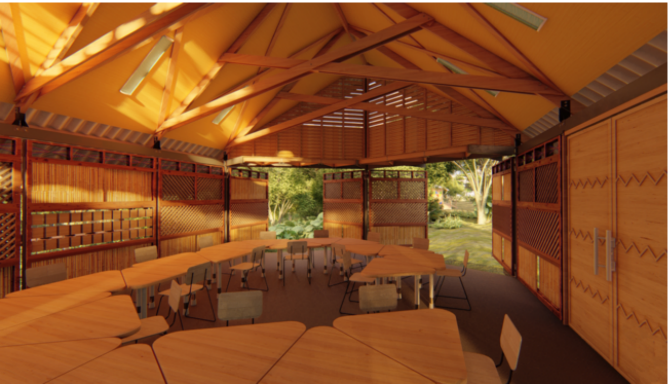
Interior del módulo B para primaria, con mobiliario adaptado a la planta de distribución y su modulación, páneles de cerramiento según cada fachada y sus necesidades, abriéndose algunos en 60° al exterior para brindar una interacción con el medio natural.
