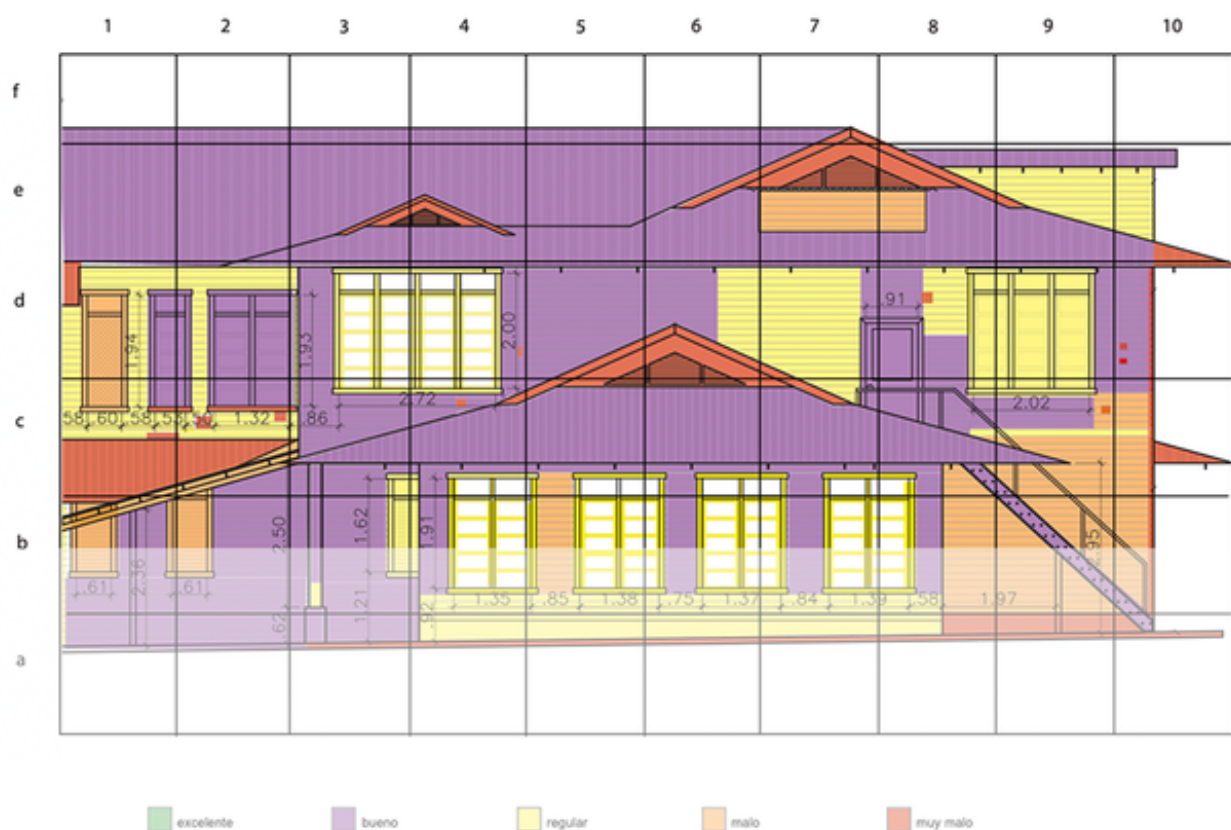
Ficha de inventario para instalaciones UCR, Recinto Golfito, Puntarenas-Costa Rica. Sección de la fachada del Edificio Administrativo 4000 de la Sede del Sur. Registro de daños y estado de conservación. Lucía Riba, Todos los derechos reservados.
